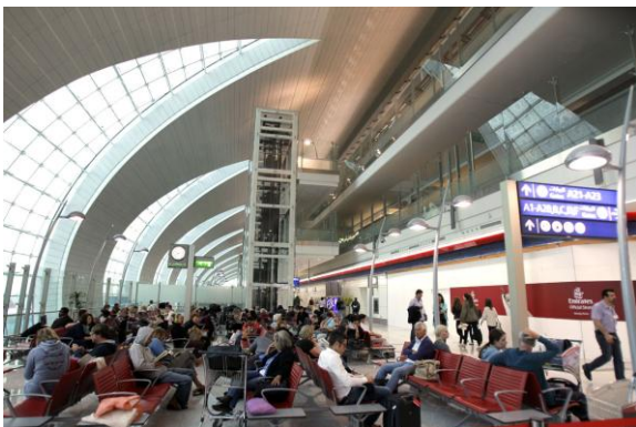
Fig. 3: Passagier Warteräume des Concourse A – Dubai International Airport – die KNX Lichtsteuerung ist mit dem Flugplan gekoppelt.
