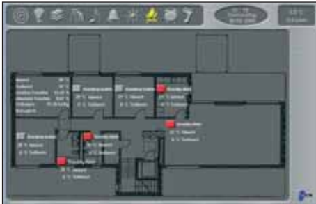
Bild 3. Beispiel Visualisierung: Bedienung und Statusanzeigen für Heizung und Lüftung
