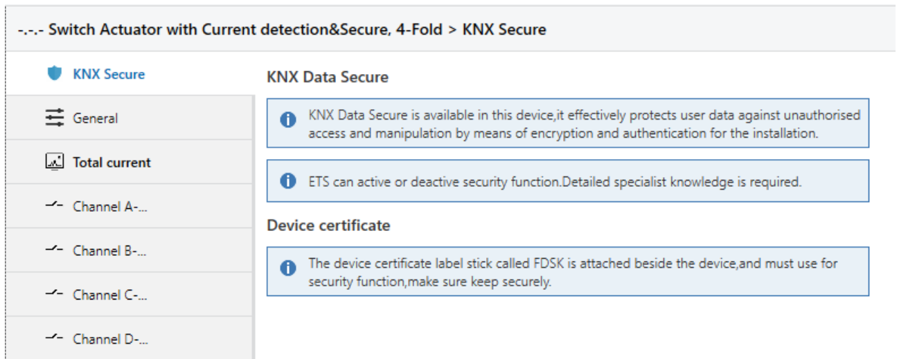
Fig.4.1 (1) "KNX Secure" parameter window
