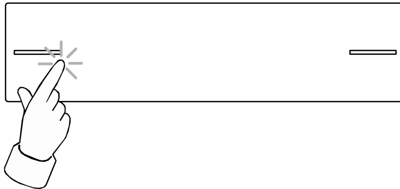
Bild 12: Wippenbedienung links (Einbaulage = Standardeinbaulage)
