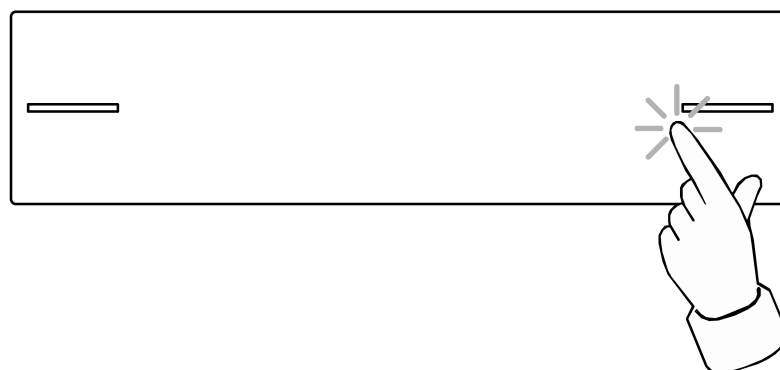
Bild 13: Wippenbedienung rechts (Einbaulage = Standardeinbaulage)
