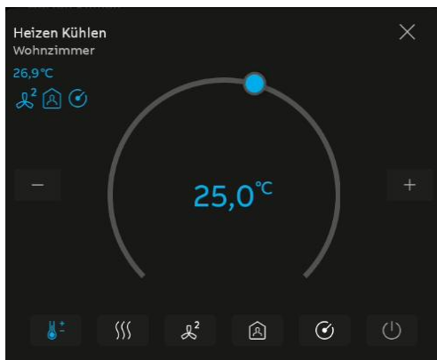
Abb. 82: Erweiterte Panelansicht Raumtemperaturregelung
