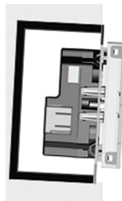
Unterputzdose falsch eingebaut
