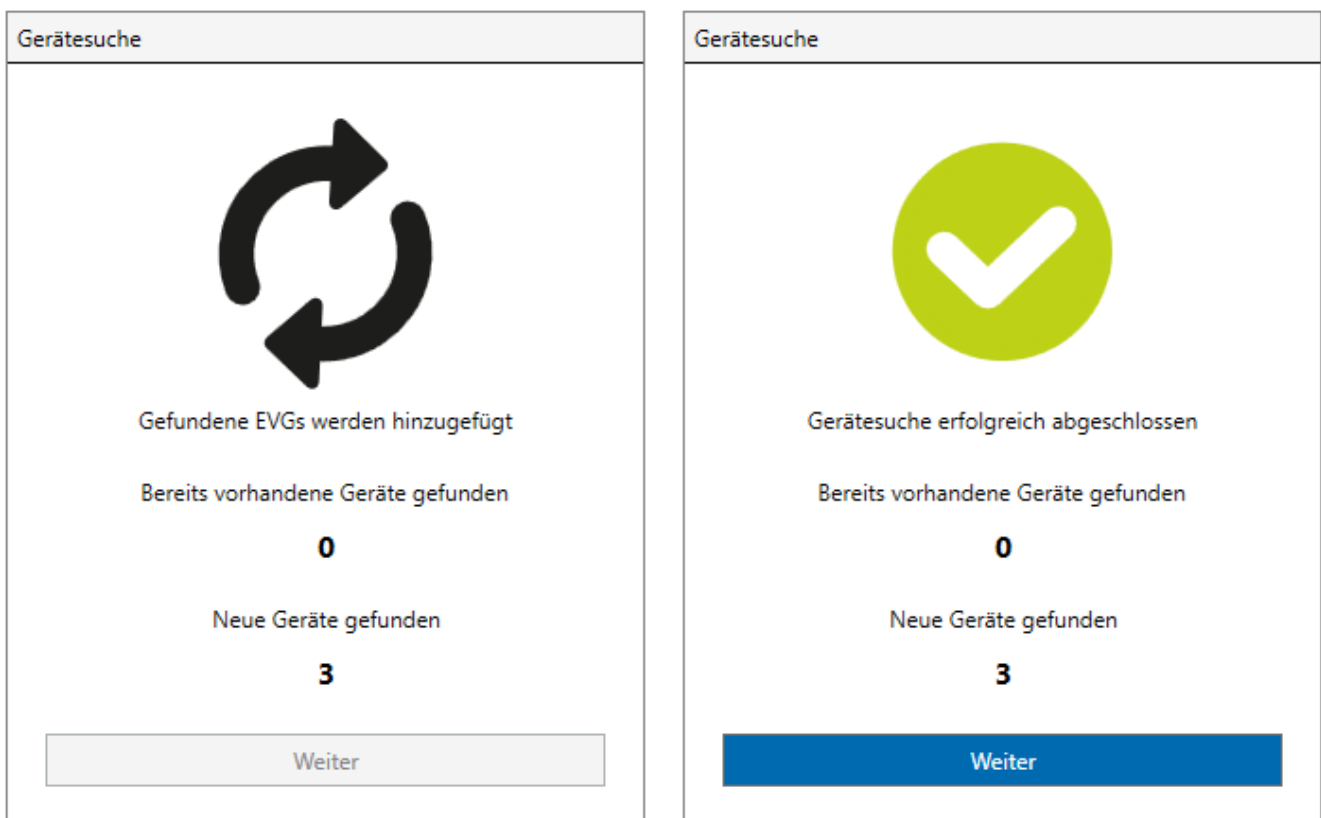
Bild 64: Beispiel für Suchfortschritt bei einer DALI-Betriebsgerätesuche (links) und fertiges Suchergebnis (rechts)
