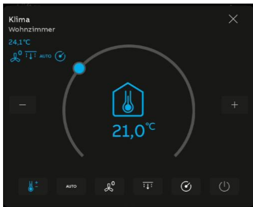
Abb. 74: Erweiterte Panelansicht Klimaanlage
