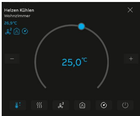
Abb. 82: Erweiterte Panelansicht Raumtemperaturregelung
