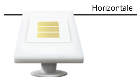
Abbildung 3: Das Gerät muss in der Querrichtung horizontal (waagrecht) montiert sein.
