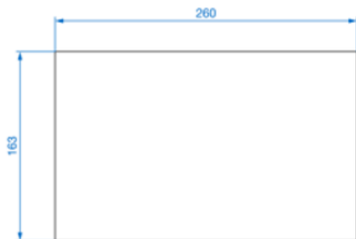
Figure 5: Découpe, dimensions, toutes les indications en mm
