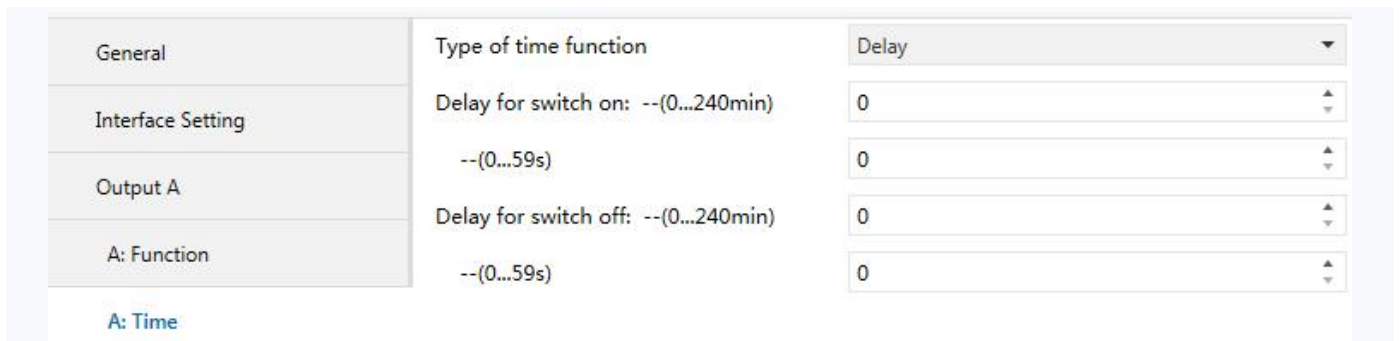
Fig. 4.5 parameter window "X: Time-Delay "
