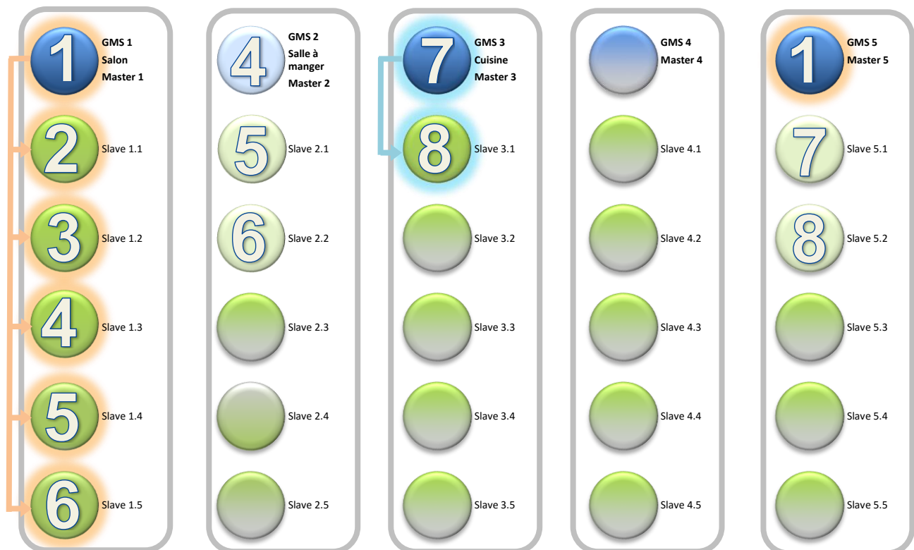
Schéma 4: Exemple de configuration avec un ise smart connect KNX Sonos. Regroupement en un groupe d'appareils Sonos des locaux Salon et Salle à manger.
