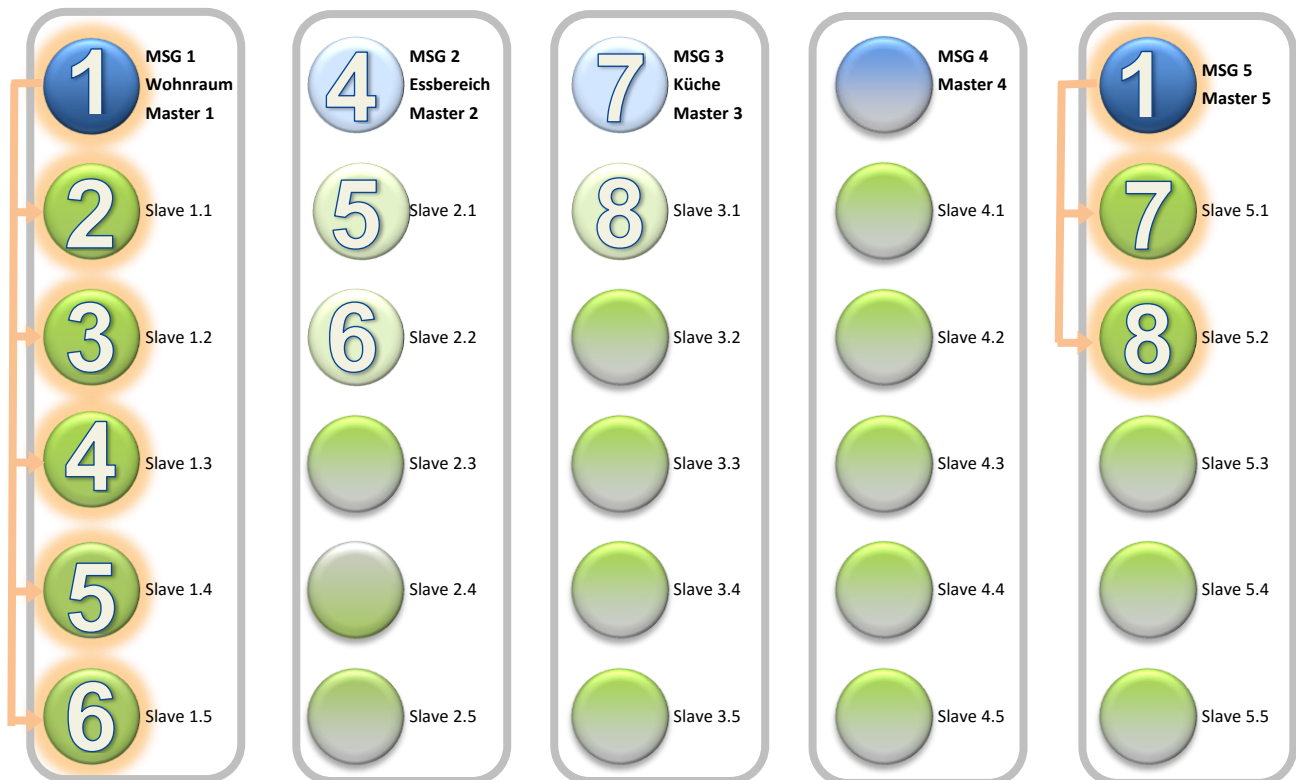
Schema 5: Beispielkonfiguration mit einem ise smart connect KNX Sonos. Zusammenfassung aller Geräte zu einer Zone (Partymodus).
