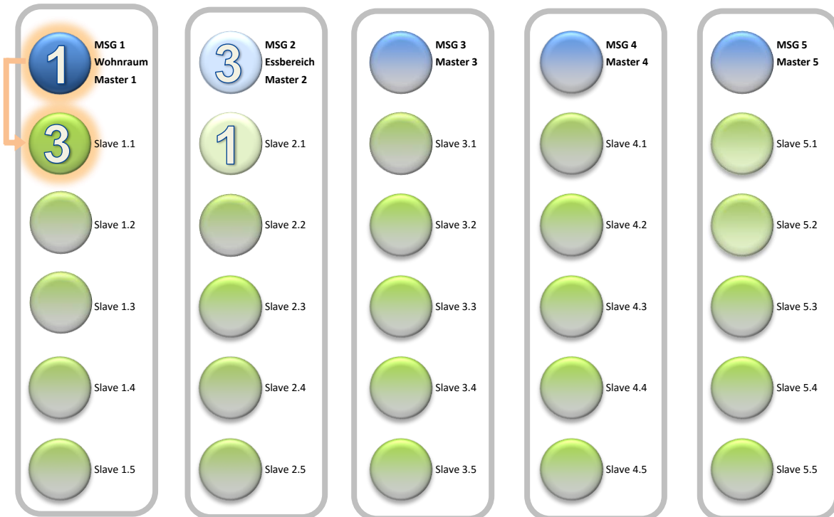
Schema 2: Zwei Stereopaare mit einem ise smart connect KNX Sonos. Beide Stereopaare werden über den Master 1 (Sonos-Gerät 1) gesteuert und spielen die Musik des Wohnbereiches.
