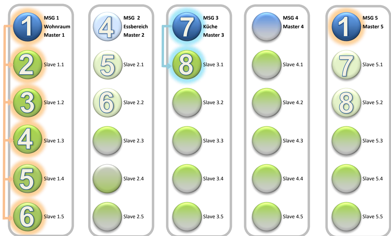
Schema 4: Beispielkonfiguration mit einem ise smart connect KNX Sonos.
