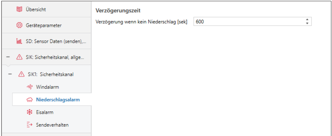
Abb. 19 Parameterdialog: SIKn: Sicherheitskanal, Niederschlagsalarm
