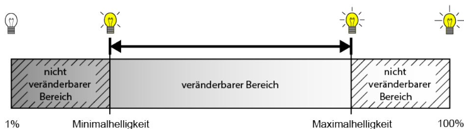
Bild 27: Helligkeitsverlauf beim automatischen Helligkeitsdurchlauf
