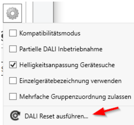
Bild 82: DALI Reset-Kommando im Kontextmenü der DALI Inbetriebnahme
