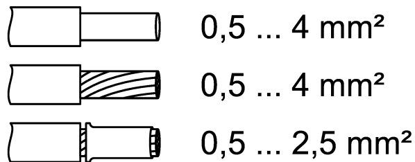
Bild 2: Klemmbare Leiterquerschnitte
