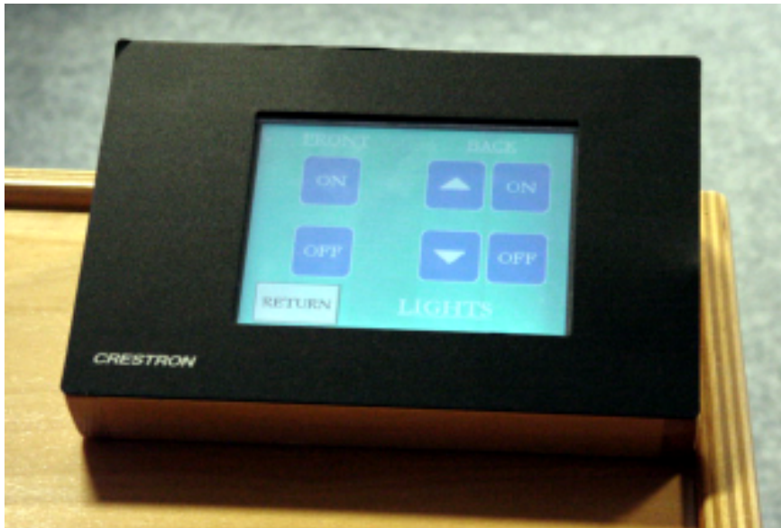
Touch-Panel für die gemeinsame Bedienung der Medien- und EIB-Anlage
