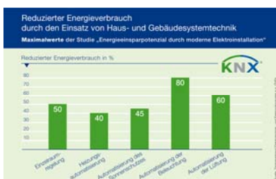
Immagine 2: riduzione del consumo di energia mediante l'impiego di KNX
