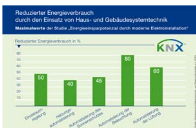
Afbeelding 2: Gereduceerd energieverbruik door de toepassing van KNX.
