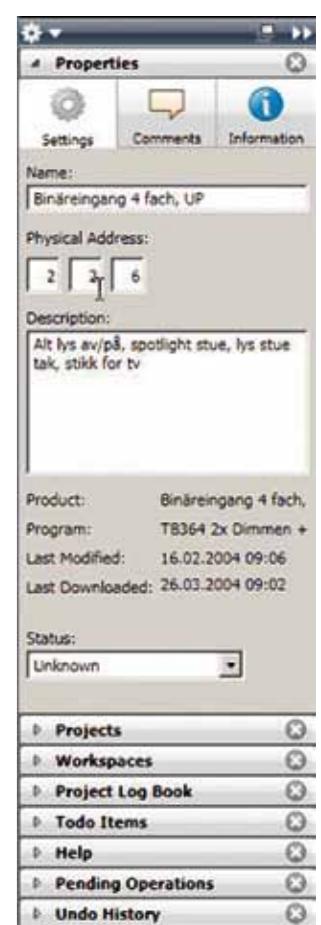
Während der Projektbearbeitung informiert die frei platzierbare SideBar über Eigenschaften eines einzufügenden Produkts, Physikalische Adresse usw.
