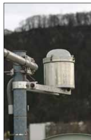
Figur 2. Uppvärmd mätutrustningen med ljusvärde sensorer placerad på en container. Källa: Schäcke
