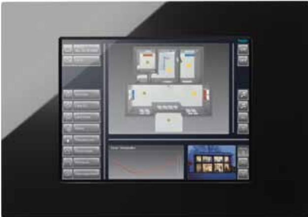
KNX visualisatie van de binnentemperatuur / KNX visualisation of the indoor temperature
