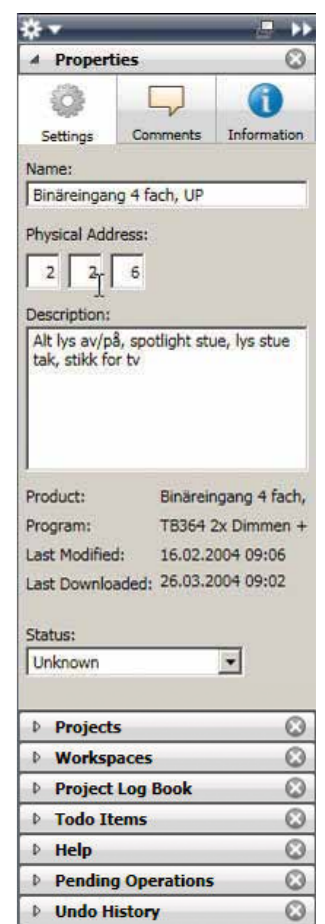
During project processing, the freely-positionable sidebar provides information on the properties of the product to be inserted, including its physical address, etc. Während der Projektbearbeitung informiert die frei platzierbare SideBar über Eigenschaften eines einzufügenden Produkts, Physikalische Adresse usw.
