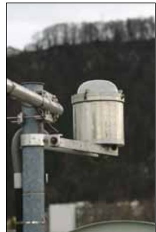
Figura 2. El contenedor de medición térmico con los sensores de valores de luz. Fuente: Schäcke
