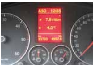
Momentanverbrauchsanzeige im Auto Fuel consumption indicators in cars
