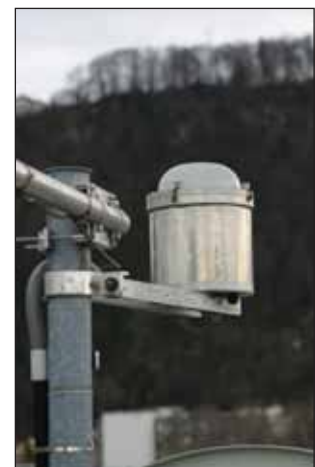
Bild 2. Der beheizte Messtopf mit den Lichtwertaufnehmern.
