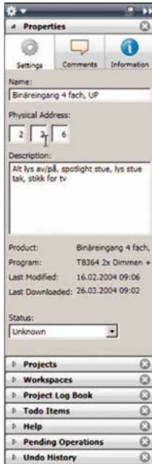
Tijdens het verwerken van een project, geeft de vrij te plaatsen sidebar informatie over de eigenschappen van het product, inclusief fysiek adres, enz. Pendant le traitement du projet, la barre latérale à positionnement libre fournit des informations sur les propriétés du produit à insérer, y compris des données telles que son adresse physique, etc.
