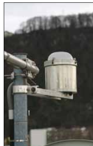
Rys. 2. Ogrzewany pojemnik pomiarowy z czujnikami natężenia światła.
