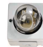
Der Tageslichtmesskopf dient der Ermittlung der Blendung durch die Sonne.
