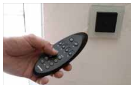
Bild 2. Die komplette Haustechnik kann über KNX RF Fernbedienung komfortabel gesteuert werden.
