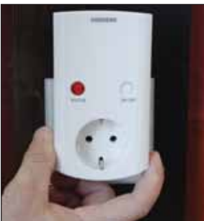
Bild 4. Die KNX RF Technik kann jederzeit einfach nachgerüstet werden. Figure 4. The KNX RF technology can easily be retrofitted at any time.
