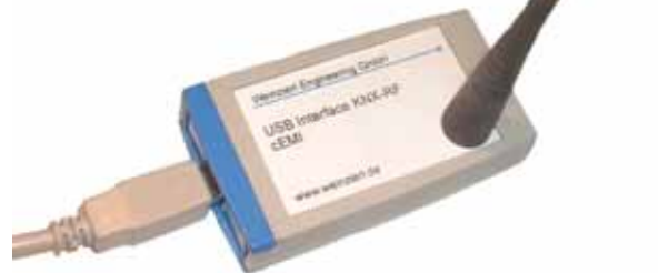
Interfaccia USB per KNX-RF. Foto: Weinzierl USB Interface for KNX-RF Photo: Weinzierl
