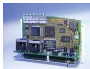
KNX IP Plattform / KNX IP Plattform
