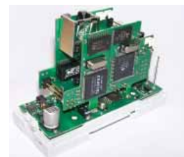
KNX IP Plattform / KNX IP Plattform
